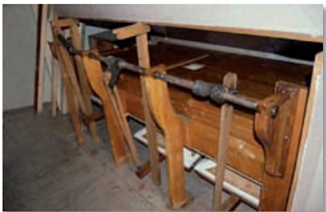
Uno dei mantici a lanterna con le pompe per il caricamento manuale
